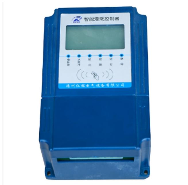
主要特点：阀门终端测试功能：方便安装人员检测阀门与站点连接情况，保证每一站点都能够正确且顺利连接；防雨：箱体宽松设计，便于安装操作，并有箱锁设计，可以防止雨淋；内置通讯模块，可实现片区组网灌溉，实时监控（有线、射频无线或GPRS网络）。程序参数：1、可以设定灌溉周期：单号日灌溉、双号日灌溉、按设定间隔天数（1—31）周期灌溉或指定星期几灌溉2、每站运行时间可以按1分钟递增量设定（支持精确到秒），运行时间0—6小时；3、程序每天灌溉起动次数\*\*多12次（即每个程序\*\*多4次）山东自动灌溉控制器非接触式开关机，射频防\*\*，无线读写数据。
